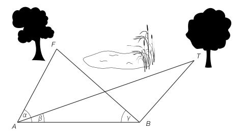
Zur Berechnung der Entfernung werden zunächst von der 10 m langen Standlinie AB die folgenden Winkel gemessen:
